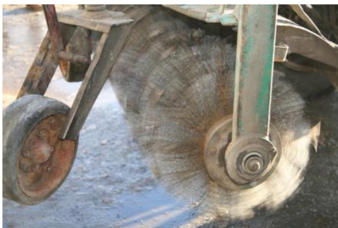
Рисунок 3.68 – Фрагмент работы инерционно-ударного рабочего оборудования по разрушению СЛО и ледяного покрытия дорог
