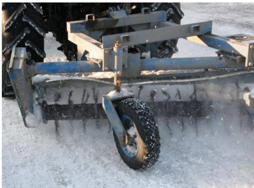
Рисунок 3.78 – Опытно-промышленный образец инерционного льдоскалывателя ударного действия, установленный на базовой машине (ТОО «ЮА Трансстрой»), в работе при 240 об/мин
