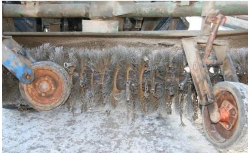
Рисунок 3.76 – Вариант опытно-промышленного образца льдоскалывателя, сочетающий в своей конструкции ударные звенья со щеточными
