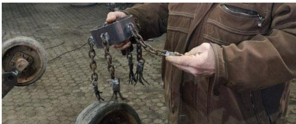
Рисунок 3.75 – Подбор экспериментальных звеньев льдоскалывателя для сборки в навесной РО (на производственной базе ТОО «ЮА Трансстрой»)
