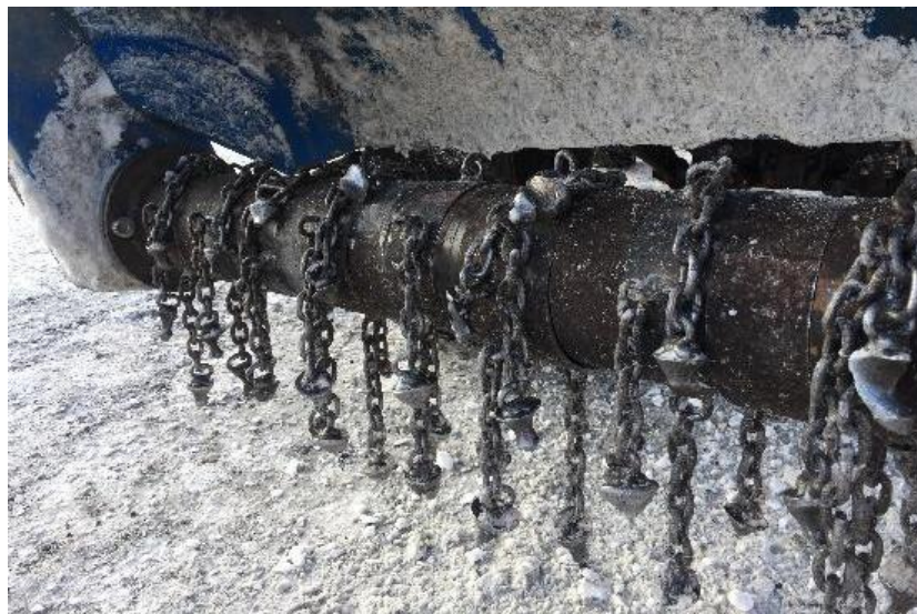
Рисунок 3.77 – Рабочий орган льдоскалывателя (базовая машина ТОО «ЮА Трансстрой») с гибкими цепями и полусферическими ударниками в нерабочем, свободном состоянии
